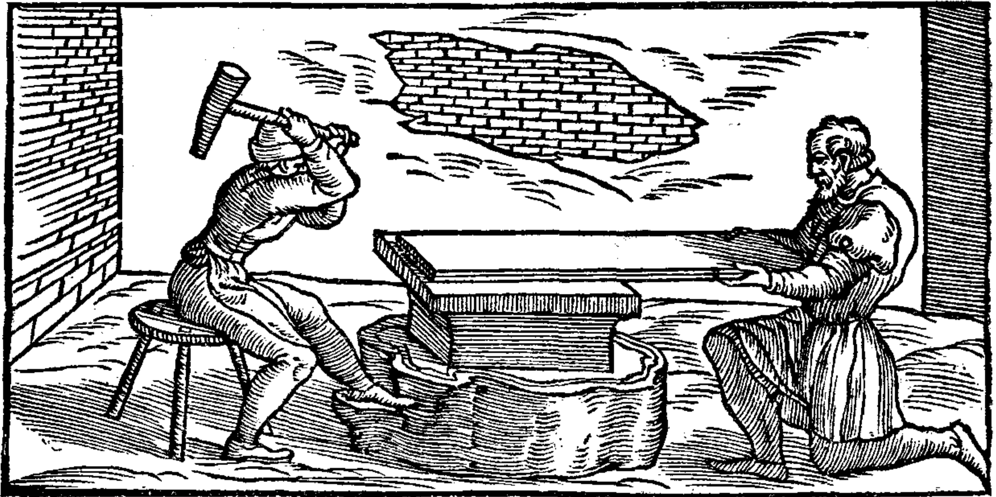
327. Изготовленіе листовъ въ началѣ шестнадцатаго столѣтія; по Birunguccio.
